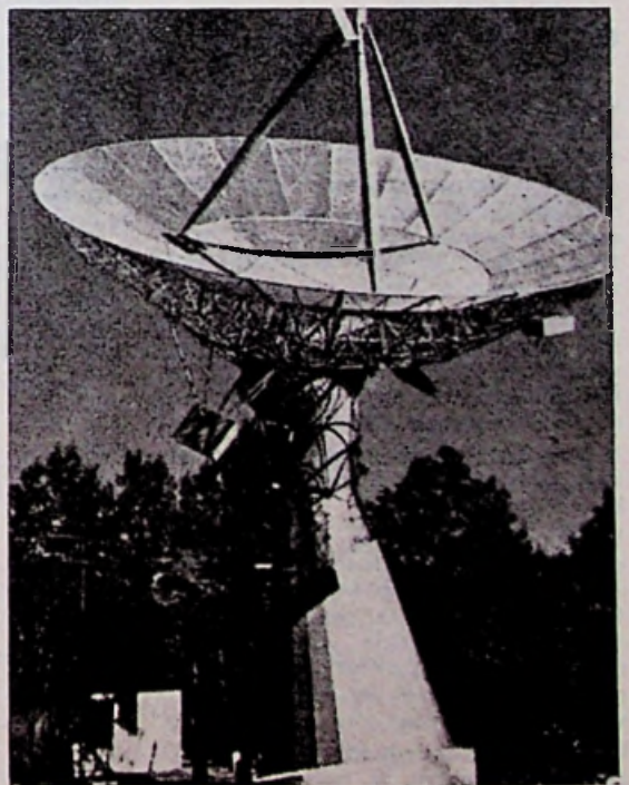
Parabolische spiegel met MASER in het voedingspunt (Harvard Univrrsity).
